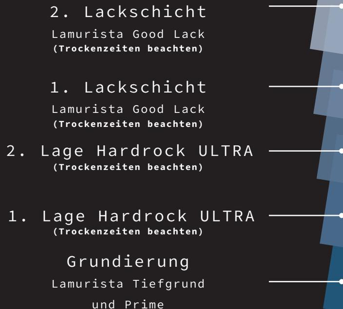
Der hier dargestellte Systemaufbau für HardRock PRO und HardRock ULTRA setzt einen mangelfreien Untergrund voraus. Notwendige Vorarbeiten (z.B. Gewebearmierung, Glättspachtelung (Q3) oder Ausgleichsmassen) für einen homogenen Untergrund sowie die Abdichtung nach der aktuellen DIN Vorschrift werden hier nicht dargestellt.
